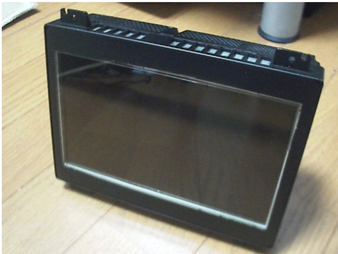
写真10 塗装した液晶ディスプレイ(LQ070T5BG01)
